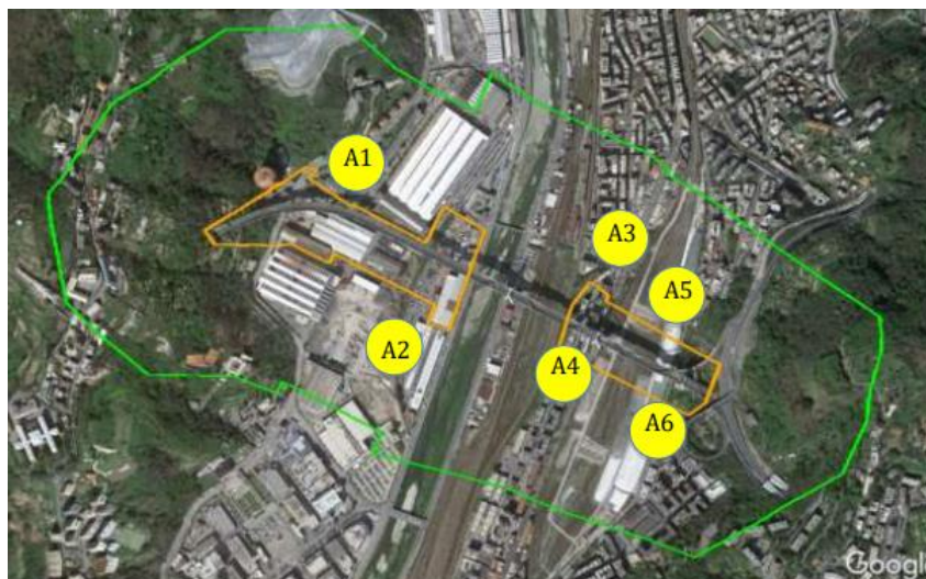
Figura 59. Postazioni rilevazione qualità dell'aria.
